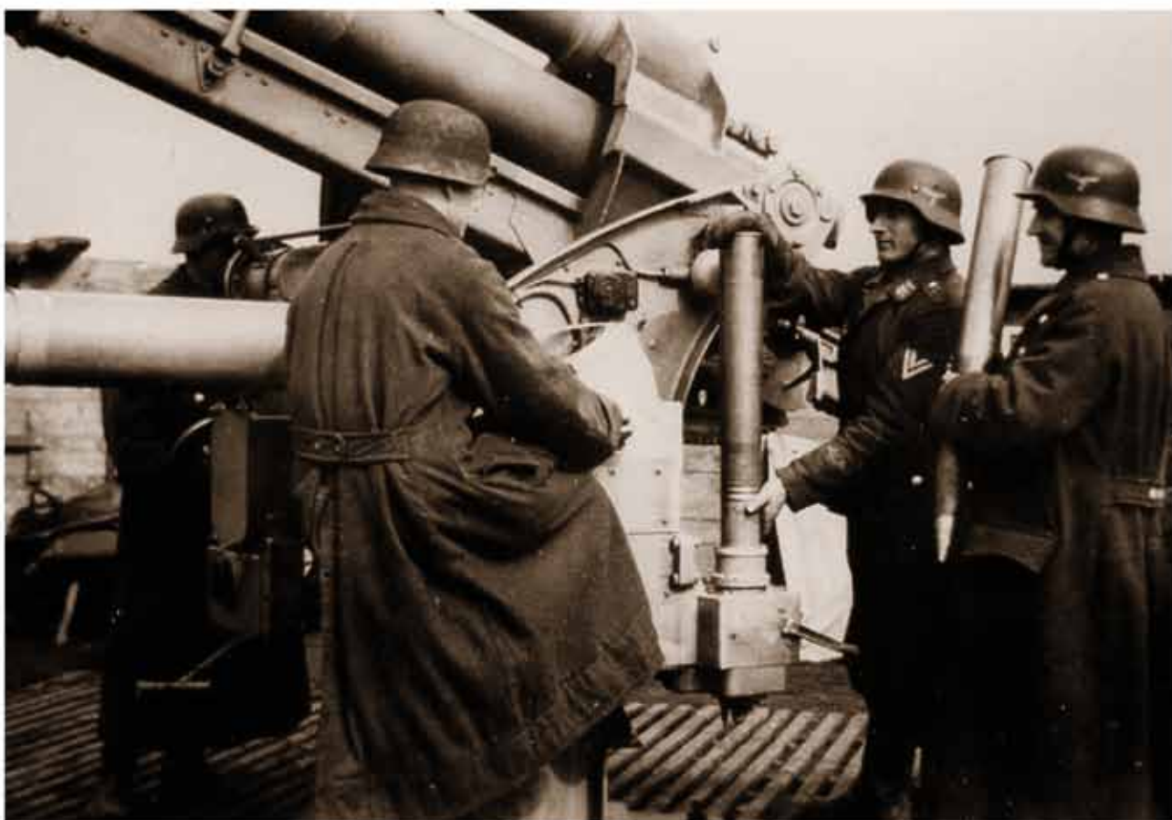
Postazione antiaerei della Flak munita di cannone 88. Il servente seduto controlla l'apparato Zundersteller di regolazione automatica spoletta a tempo (max 30 sec.) della granata alla quota indicata dalla centrale di tiro.
